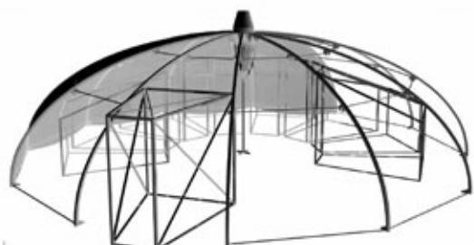
we put up the frame with the help of middle column... con l'aiuto del pilastro di mezzo la carpenteria va montata...
